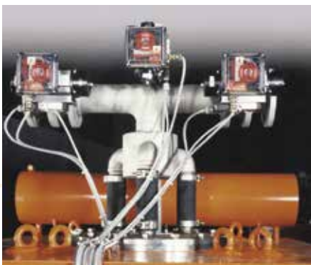
Ventilaufbau einer automatischen Anlage.
