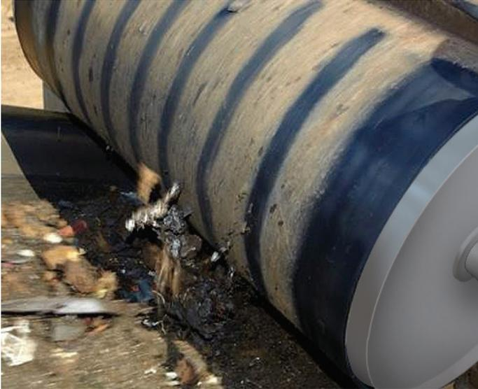
Die magnetischen Kopftrommeln sind die ideale kompakte Lösung für die magnetische Separation von Fördergütern.
