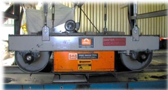
原料の中に混入している鉄片は機械設備を破損し、工程を止め、ダウンタイムをもたらします。
