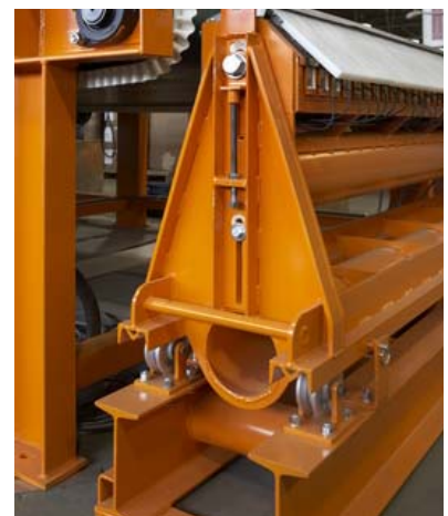
エリーズの電動パドルアレイは、 上下、前後、角度付上下動の6 つの動きをします。
